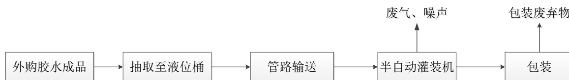
图 3-4 胶水灌装工艺流程及产污环节
